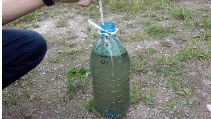
2.8 pav. Vandens mėginio temperatūros matavimas ėmimo vietoje
